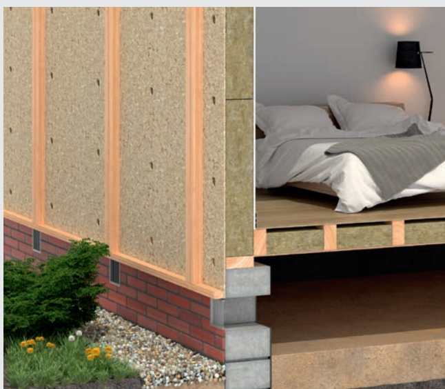
Nabicie poszycia z płyt OSB z nawierconymi otworami oraz rusztu pod zewnętrzne ocieplenie.
