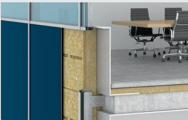
Zamocowanie gotowej okładziny elewacyjnej.
