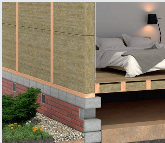
Ułożenie pierwszej warstwy wełny między słupkami drewnianymi.
