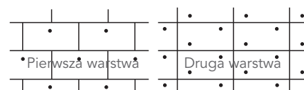
Rozmieszczenie łączników w pasie środkowym.
