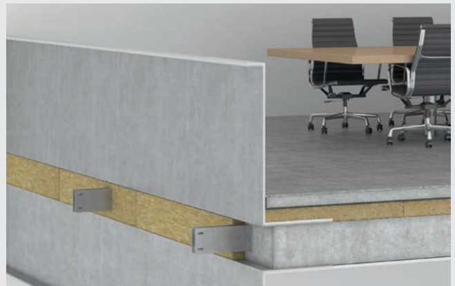
Uszczelnienie wełną na grubości stropu.
