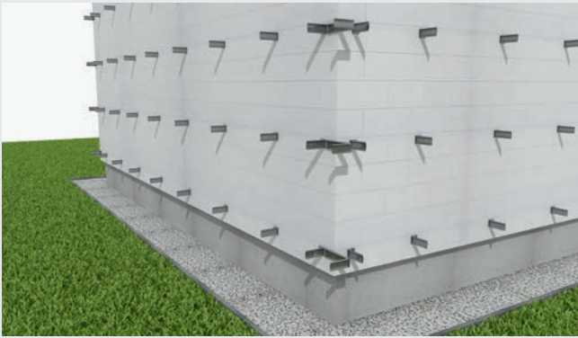
Montaż konsoli do ściany.
