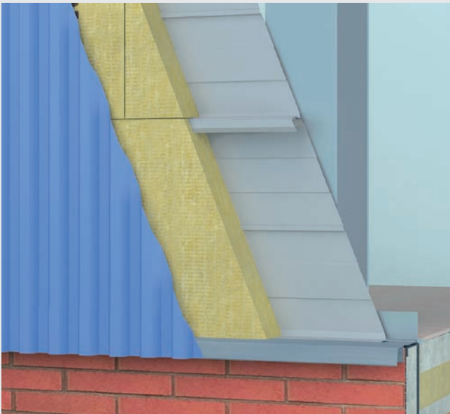
Przykręcanie blachy elewacyjnej.
