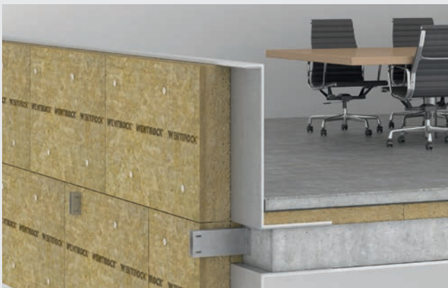
Ułożenie i zakłkowanie zasadniczego ocieplenia z wełny.
