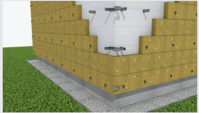
Ułożenie i zakolkowanie wełny do ściany.
