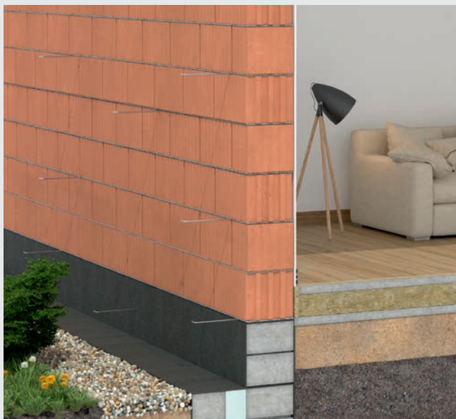
Pozostawienie w ścianie kotew stalowych.
