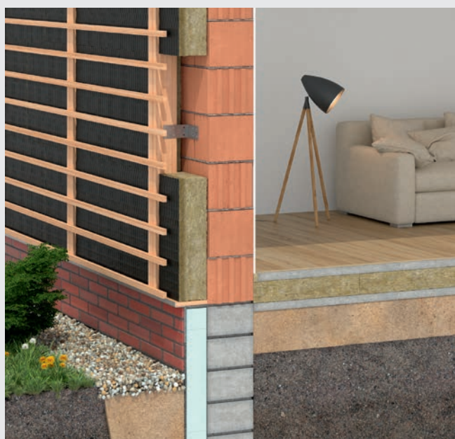
Zamocowanie łąt pod łupek elewacyjny.
