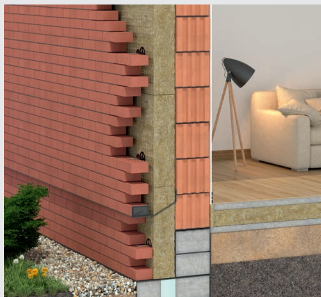
Wymurowanie warstwy osłonowej z klinkieru.
