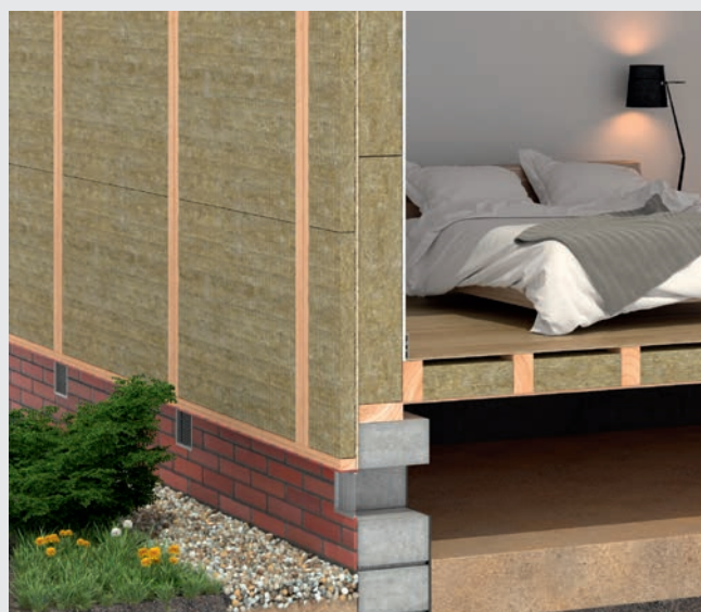
Ułożenie drugiej warstwy wełny między elementami rusztu.
