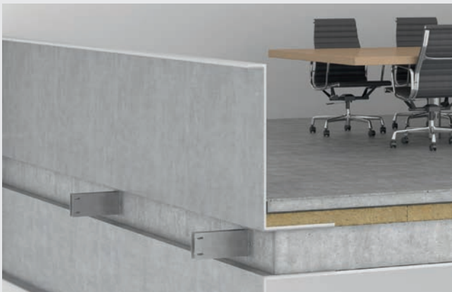
Umocowanie konsol do podłoża.
