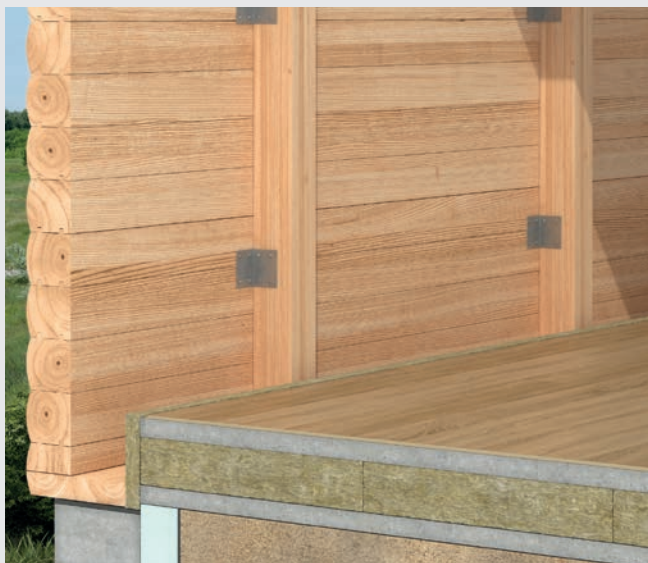
Przymocowanie słupków do bali za pomocą ażurowych wieszaków metalowych.
